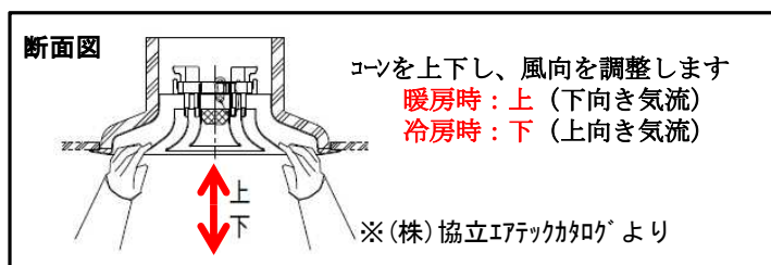
写真6 シーリングディフューザー
